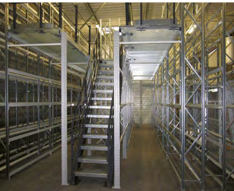
Installation de rayonnages ACTI·VOL double face pour le stockage de pneus sur toute la hauteur du bâtiment avec accès et plancher caillebotis (Actiflip)
