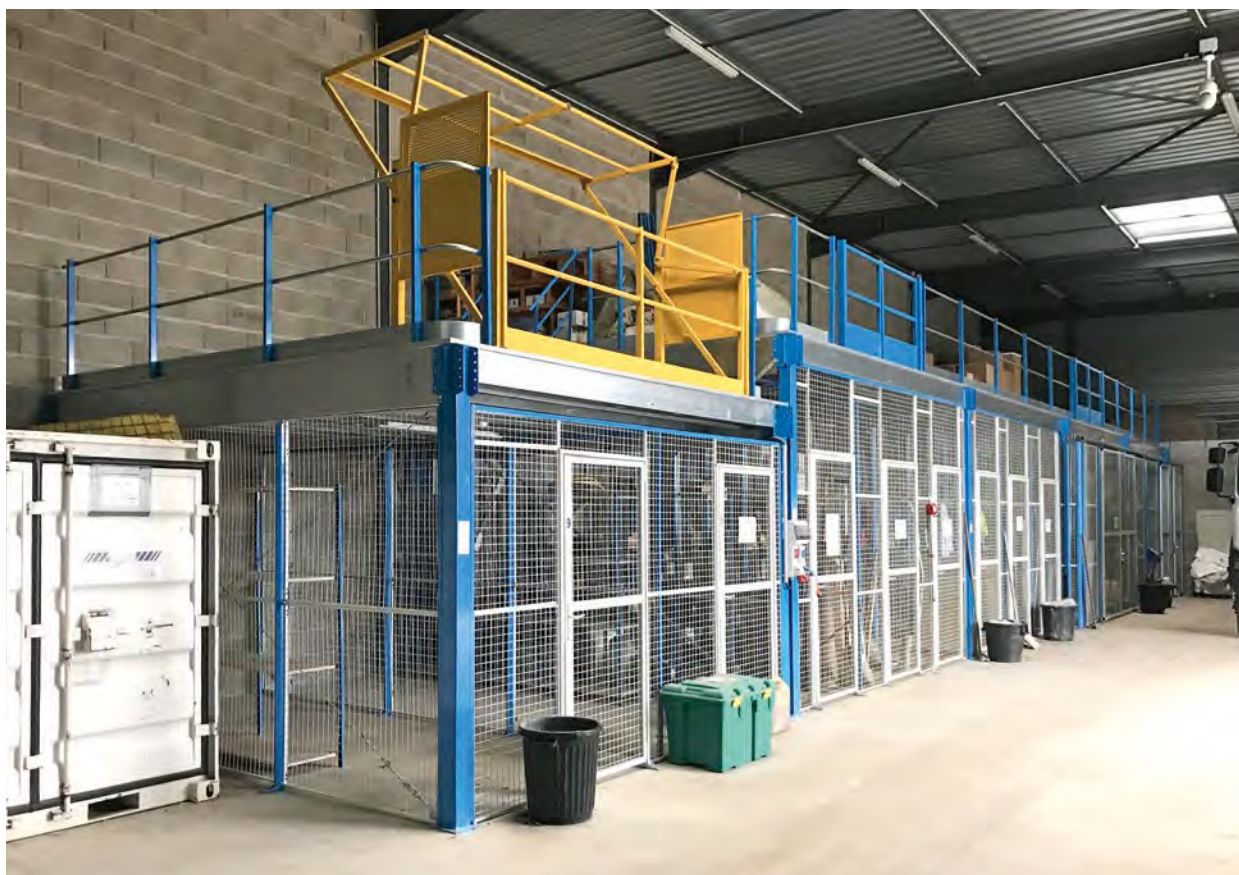
Sécurisation de stocks de pièces détachées sous une structure de plateforme (Araydis)
