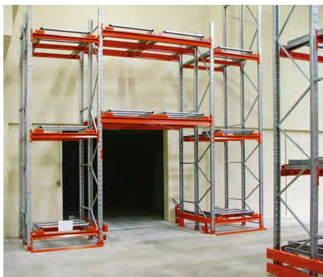
Mise en place d'une solution « push back » pour augmenter le nombre de palettes entreposées dans une zone de stockage compacte (Gallorema)
