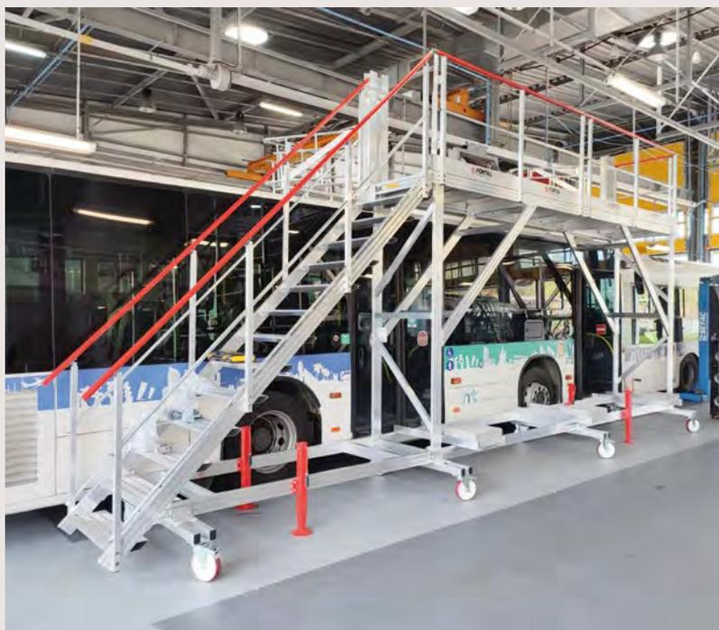
Plateforme mobile accès toiture bus
