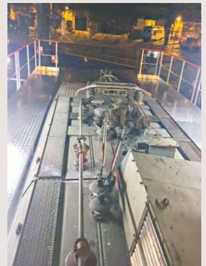
La mise en place des passerelles tout autour de la motrice assure une surface de travail sécurisée contre les chutes de hauteur
