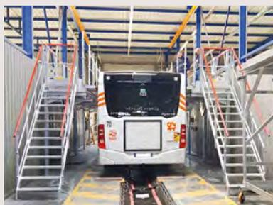
Passerelles fixes pour maintenance en toiture de bus
