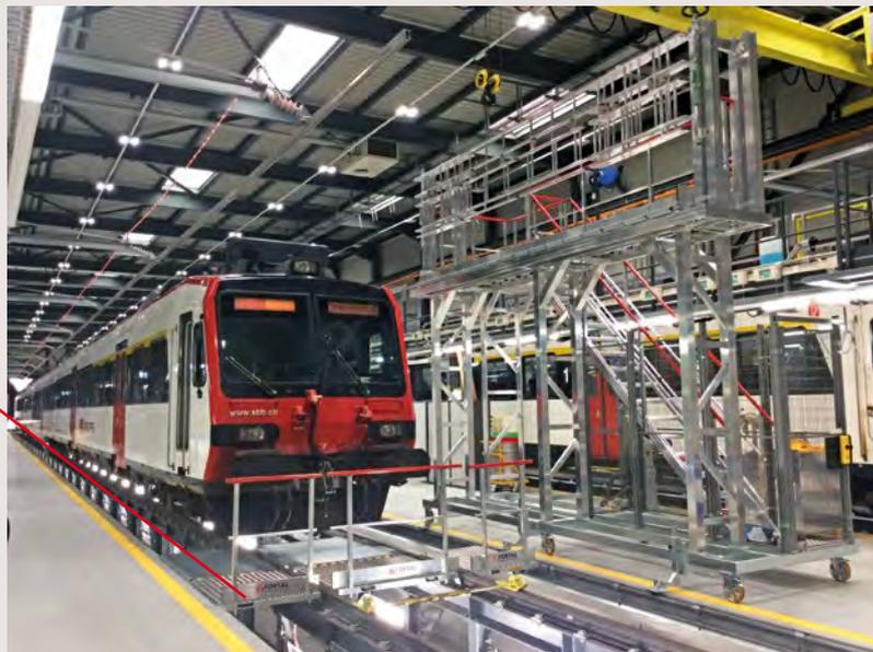
Plateforme en position garde-corps repliés - châssis en acier galvanisé. Au premier plan : passerelle pour passage de rails et escalier amovible pour descente dans la fosse.
