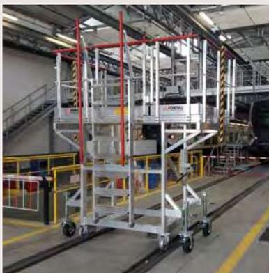
Plateforme accès nez de train avec double système de déplacement roues caoutchouc et roues de guidage sur rails
