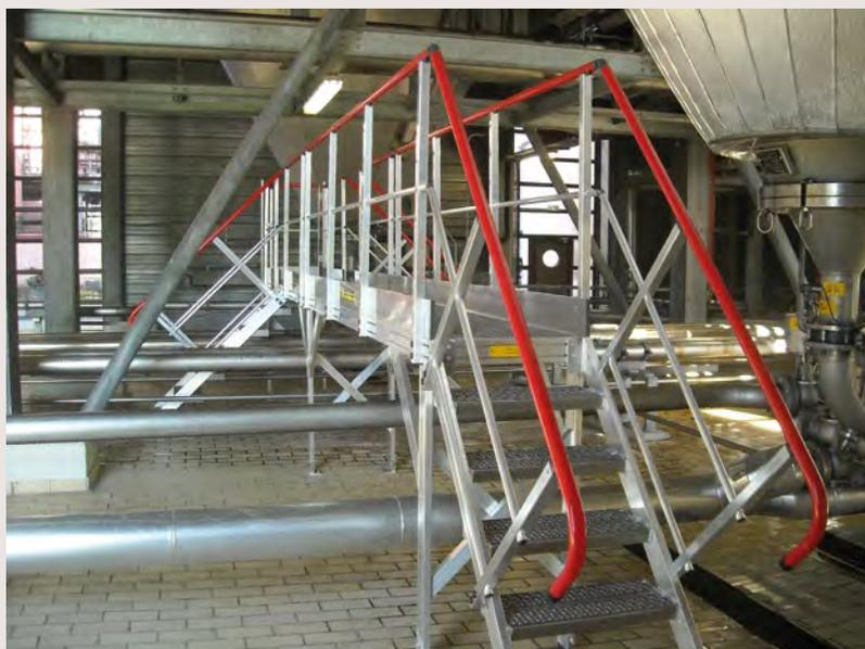
Passerelle de franchissement d'une chaîne de fabrication
