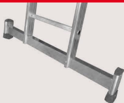
Les échelles utilisables comme échelle d'appui à partir d'une longueur de 3 mètres sont équipées d'un dispositif de sécurité contre l'écartement. Ce dispositif se présente sous la forme d'un stabilisateur en aluminium équipé de patins dont la largeur varie en fonction de la longueur de l'échelle.
