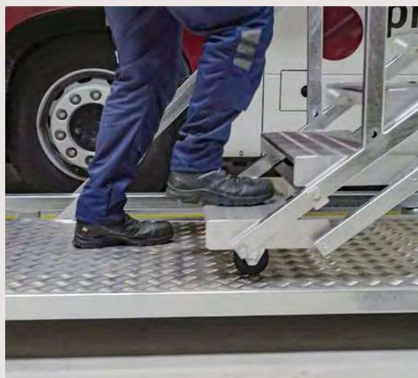
Escalier à angle variable de 35° à 55° en fonction de la hauteur. Marches en aluminium strié antidérapantes profondeur 261 mm. Conformité ISO 14122-1-2 et 3
