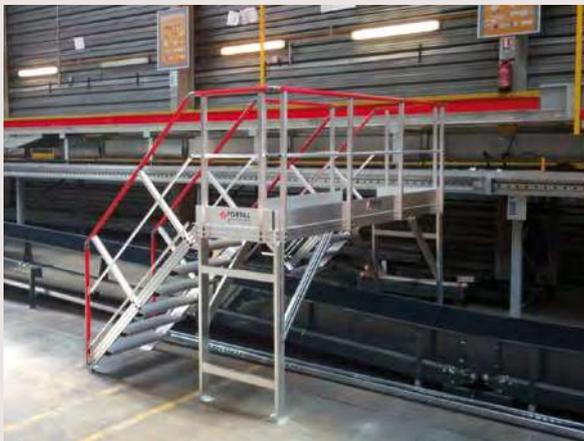
Escalier double accès pour passage au-dessus d'une ligne de conditionnement
