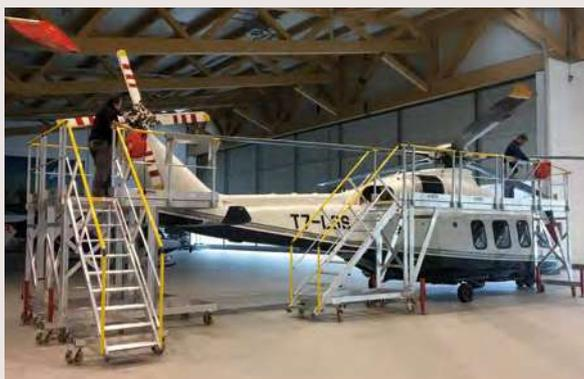
Plateformes accès latéraux et poutre de queue
