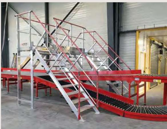
Escalier double avec passerelle au-dessus d'un convoyeur
