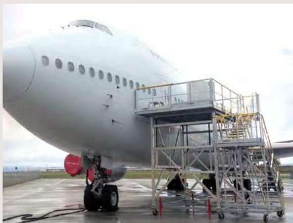
Passerelle d'accès et de stockage maintenance B747
