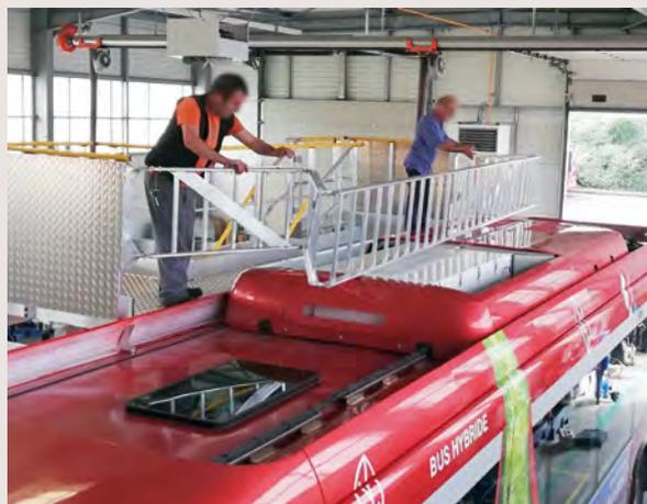
Garde-corps entrain d'être déployés en toiture de bus
