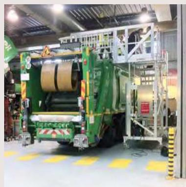
Plateforme mobile de maintenance actionnée par vérin électrique pour véhicules de différents gabarits
