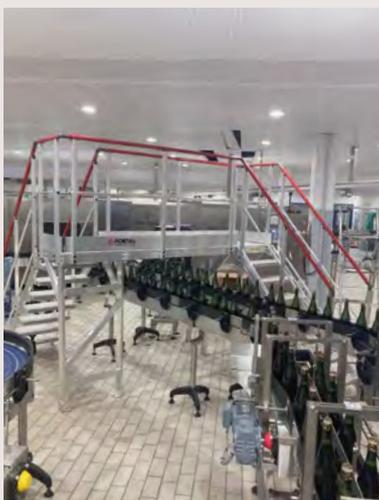
Passerelle d'habillage au-dessus d'une ligne de fabrication
