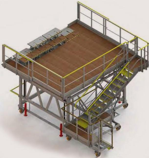
Vue 3D passerelle réglable en hauteur Airbus A319-320
