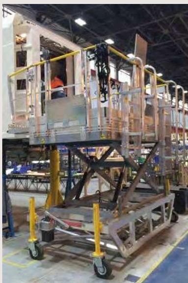
Plateforme de maintenance à ciseaux réglable en hauteur pour wagon
