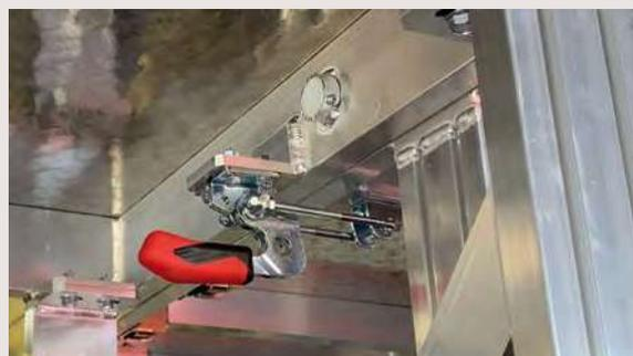
Assemblage entre la plateforme arrière et les plateformes latérales par picots de guidage et sauterelles
