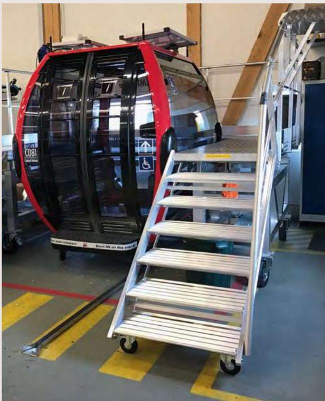
Plateforme de travail mobile en 3 modules - assemblage rapide par sauteurre - réglable en hauteur de 1,2 à 1,7 m via 2 crémaillères jumelées - Accès par 2 escaliers à angle variable - Site de fabrication de télécabines
