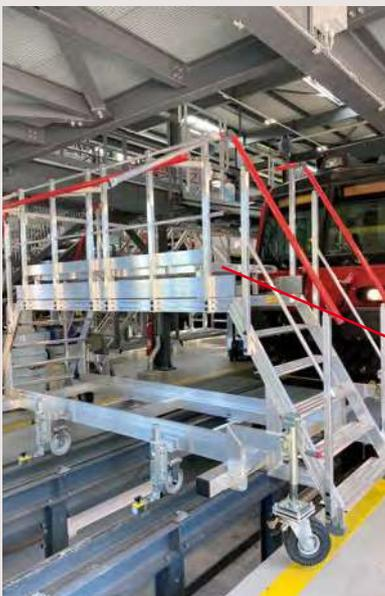
Plateforme mobile avec réhausses pour accès pare-brise - déplacement par roues à boudin pour guidage sur rails et blocs magnétiques pour immobilisation
