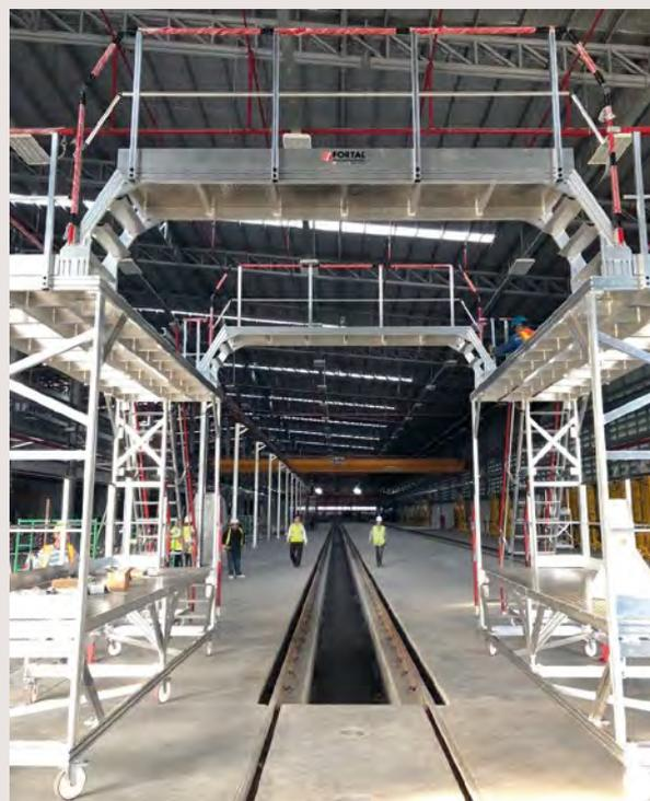
Passerelle de maintenance pour accès toiture
