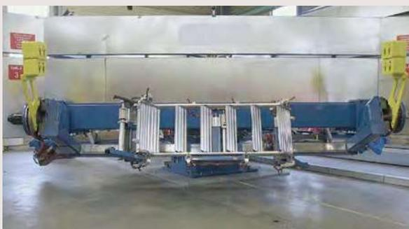
Robot de soudure pour escaliers d'échafaudages
