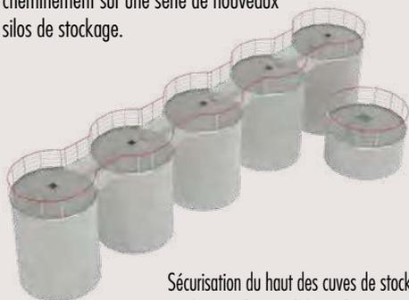
Sécurisation du haut des cuves de stockage par la pose de 63 ml de garde-corps
