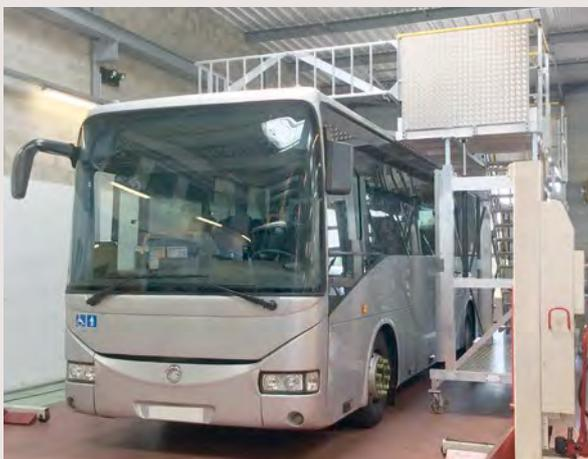
Passerelle mobile réglable en hauteur pour accès maintenance en toiture des bus
