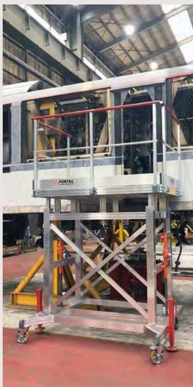
Plateforme réglable en hauteur pour chargement de matériaux
