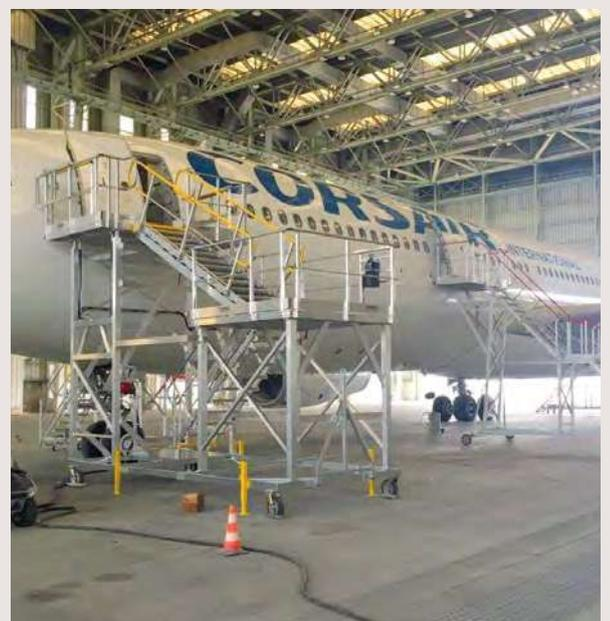
Passerelle à double niveau pour accès maintenance A340/500 et Boeing 747-400
