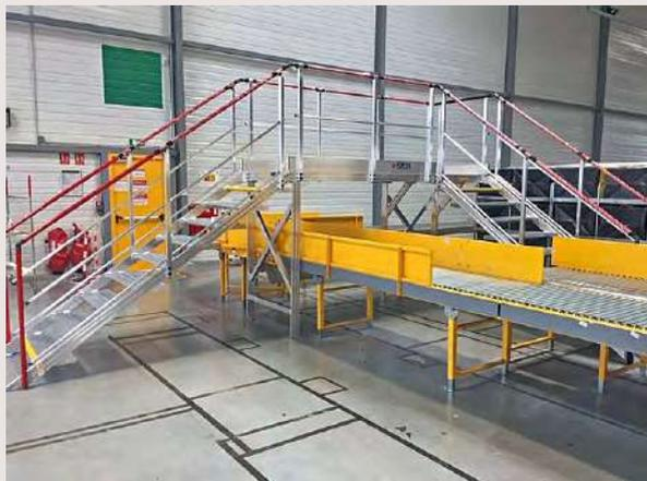
Escalier double accès pour passage au-dessus d'un convoyeur
