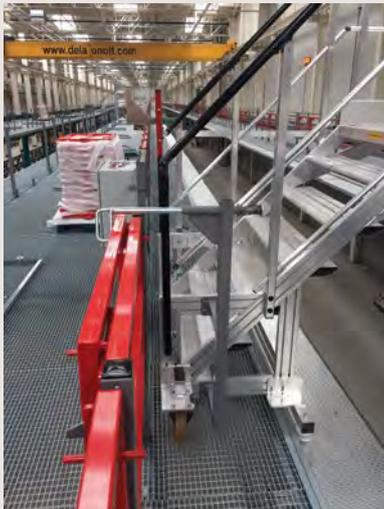
Vue sur le système de guidage par galet et sur système de levier à roulettes. Ensemble équipé d'un frein normalement fermé : l'utilisateur doit maintenir la poignée serrée pour déplacer le ponton tout en étant sécurisé de l'autre côté du garde-corps. Ce système est jumelé pour déverrouillage des roulettes des 2 côtés par 1 seul utilisateur quel que soit le côté.
