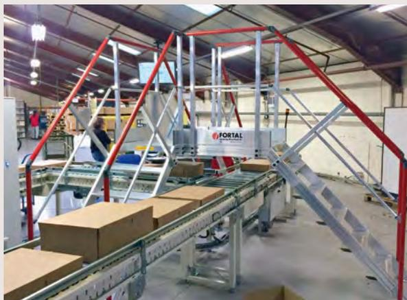
Passage de convoyeur sur ligne de conditionnement
