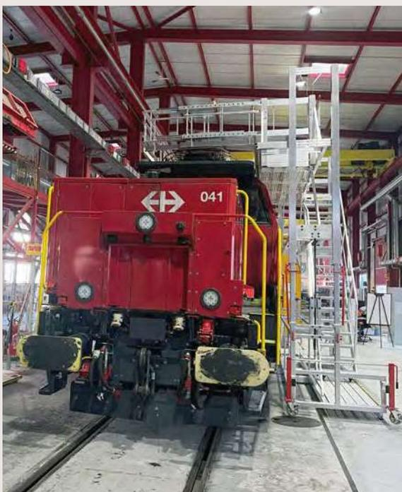
Le garde-corps se déploie en toiture pour offrir une surface de travail confortable
