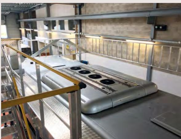
Le déploiement du garde-corps permet la mise en sécurité de l'opérateur
