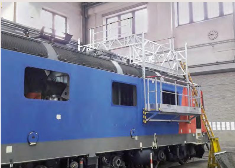
Passerelle de maintenance sur toiture de motrice
