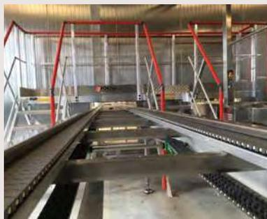
Passerelle pour passage au-dessus d'un convoyeur
