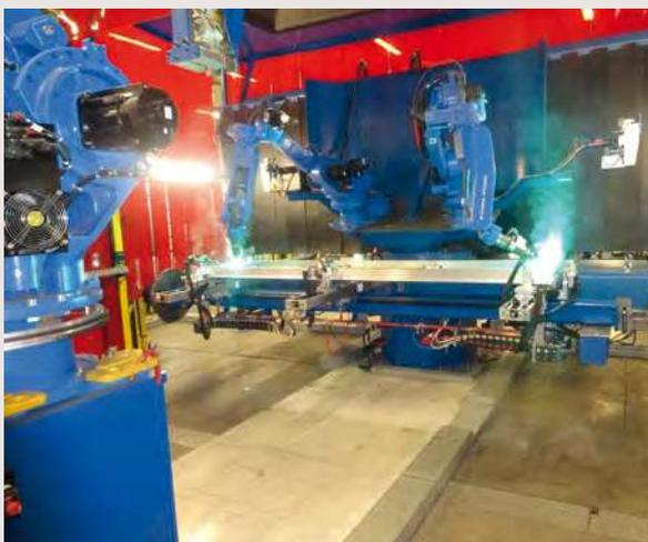
Cellule robotisée de soudure aluminium pour planchers d'échafaudages
