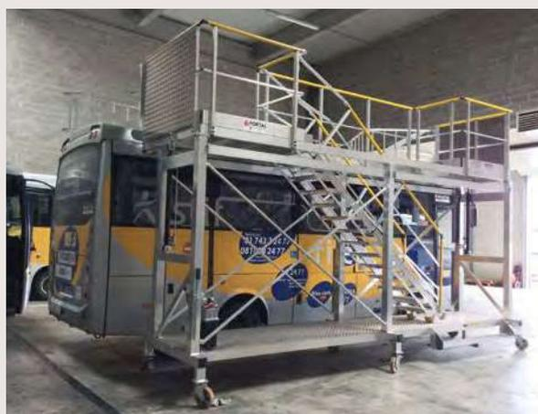
Passerelle de maintenance réglable en hauteur en situation d'utilisation
