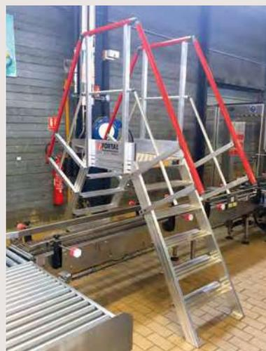
Passerelle de passage de convoyeur sur une ligne de conditionnement
