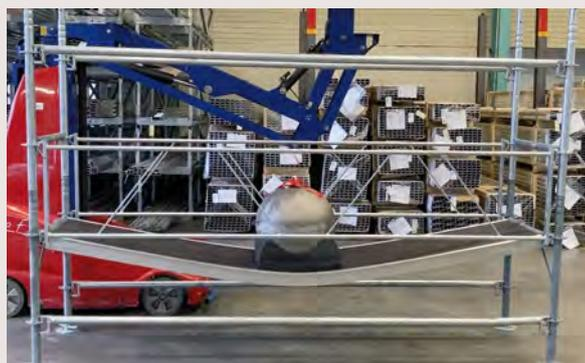
Test de résistance des planchers avec une boule en acier de 100 kg effectuant une chute libre de 2,5 m - soit un impact de 2500 kg
