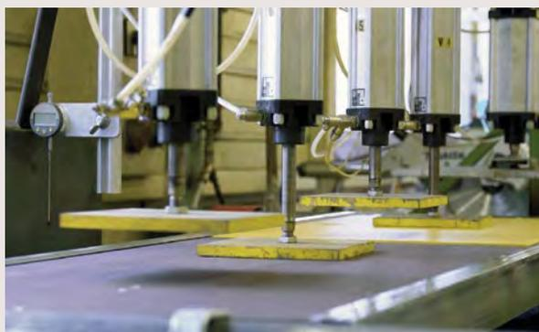
Banc de test de résistance des planchers par pression
