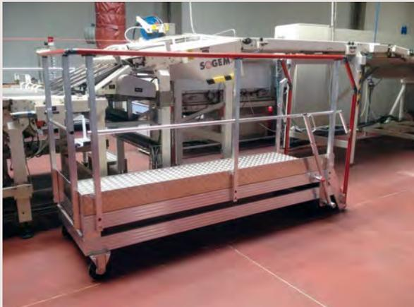
Passerelle mobile pour intervention sur chaîne de conditionnement
