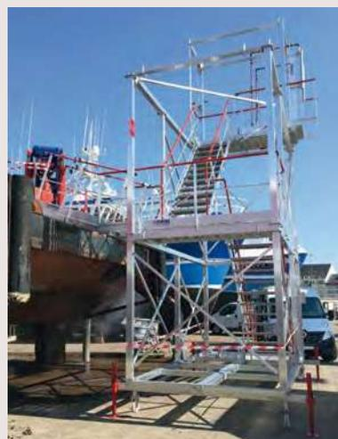
Plateforme mobile pour accès maintenance des bateaux
