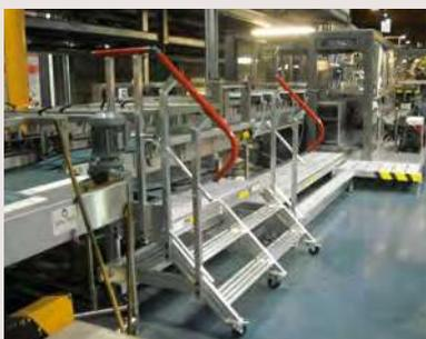
Plateforme et escabeau mobile sur chaîne de montage
