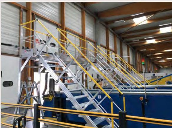
Passerelle avec escaliers d'accès sur chaîne de tri de colis
