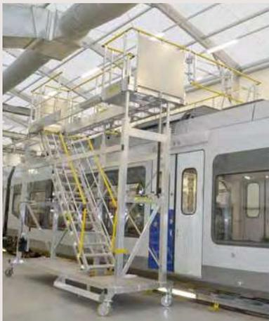
Passerelle mobile en situation sur toiture de train
